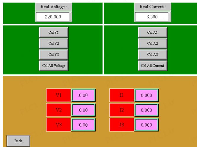
در این پنجره می توانیم ولتاژ / جریان هر فاز را به صورت جداگانه کالیبره کنیم و یا اینکه تمامی ولتاژها / جریان ها را با فشردن دکمه Cal All Voltage/ Current به یکباره کالیبره کنیم.
