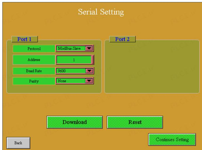
تذکر : تنظیمات انجام شده در این قسمت باید با تنظیمات انجام شده در PLC ، PC ، HMI ، ... و یا هر وسیله دیگری که دستگاه با آن ارتباط سریال برقرار کرده است یکی باشد در غیر این صورت ارتباط سریال RS485 برقرار نمی شود .
