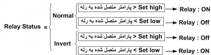
نکته : در صورتی که پارامتر متصل به رله ، پارامتر Direct انتخاب شده باشد ، برای فرمان دادن به رله میتوان از کلید Direct استفاده نمود. همان طور که در شکل فوق مشاهده میکنید ، تنظیمات مربوط به ورودی دیجیتال نیز در این صفحه قرار دارد که شامل DI Filter بوده و تعیین کننده فیلتر ورودی دیجیتال است.
